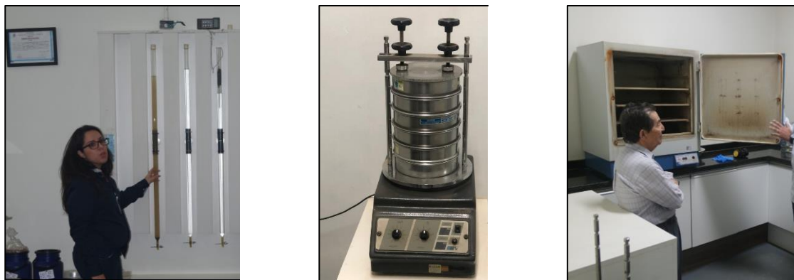
Figura 18 – Instrumentos Laboratoriais Tubo de remoção pela base - Conjunto de peneiras e agitador - Estufa de secagem
