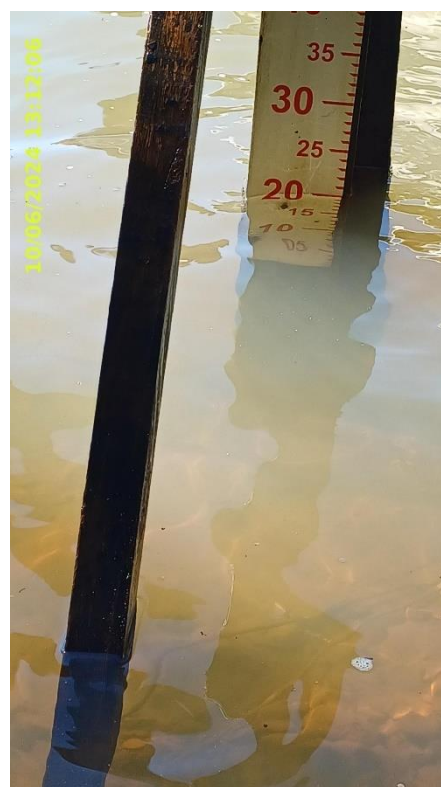
Figura 4 – Nivelamento de Réguas (Estação UHE Baixo Iguaçu Jusante)
