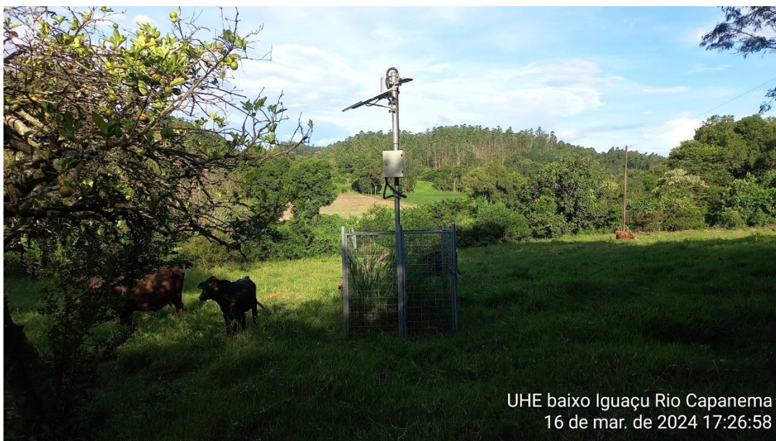
Figura 23 – Estação Telemétrica UHE Baixo Iguaçu Rio Capanema (Montante I)
