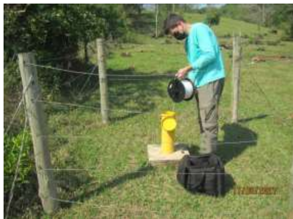
Procedimento de medição da profundidade do lençol freático.
