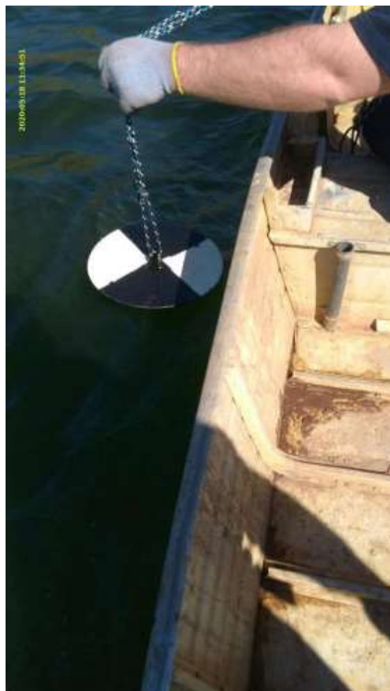
Disco de Secchi -medição de transparência realizada na estação UHE Baixo Iguaçu Barramento – 18/05/2020.
