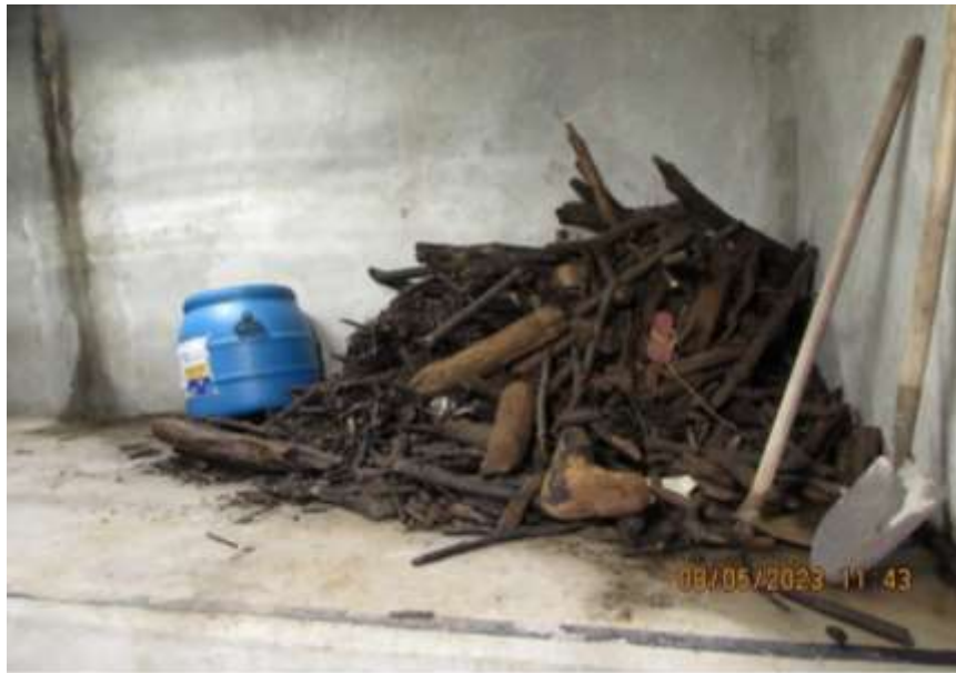
Figura 4.38 - Resíduos proveniente do reservatório retirado do ralo de esgotamento da caixa espiral
