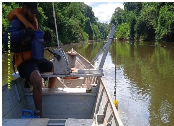
Amostragem de Sedimento em Suspensão realizada na estação Rio Gonçalves Dias – 02/03/2022.
