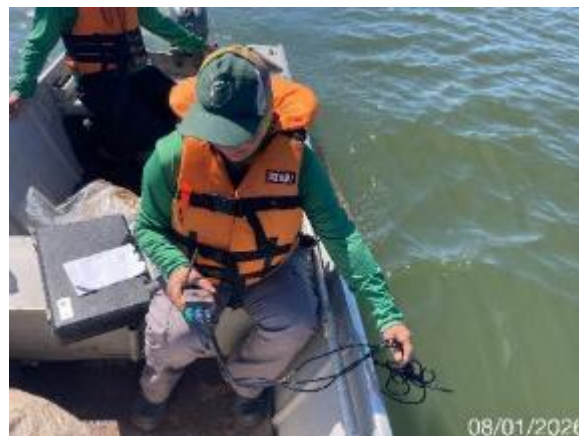
Aferição de parâmetros abióticos da água com sonda multi-parâmetros, janeiro de 2026.
