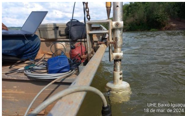
Medição Descarga líquida com ADCP na estação UHE Baixo Iguaçu Jusante - 18/03/2024
