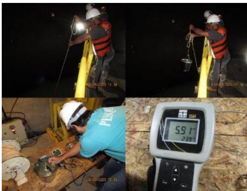
Figura 4.16.2-6. Monitoramento da qualidade da água do tubo de sucção.
