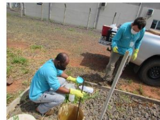
Monitoramento mensal da qualidade do efluente sanitário antes do lançamento no rio Iguaçu
